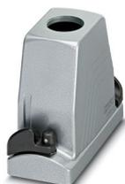
HEAVYCON ADVANCE com revestimento com pó padrão, carcaça B16, com travamento à baioneta, altura 100 mm, com rosca 1x M32, saída de cabo reta
