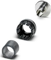
Anel de fixação de cabos e adaptador de blindagem, blindado: sim, diâmetro do feixe de fios: 4,6 mm, faixa de diâmetro de cabo: 7,5 mm ... 9,5 mm, série: NC, RC, espera-se que esse artigo seja isento de chumbo a partir de 2027-Q1, de acordo com RoHS II, sem exceção 6c (Pb < 0,1%); alternativa sem chumbo possível mediante solicitação antecipada
