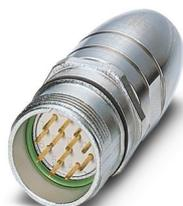
M23, Conector para acoplamentos, série: RC, reto, blindado: sim, Travamento parafusado, Número de pólos: 6+3, Sentido de rotação: Padrão, tipo de contato: Pino, Cálice de solda, faixa de diâmetro de cabo: 3 mm ... 10,5 mm, codificação: N, espera-se que esse artigo seja isento de chumbo a partir de 2027-Q1, de acordo com RoHS II, sem exceção 6c (Pb < 0,1%); alternativa sem chumbo possível mediante solicitação antecipada
