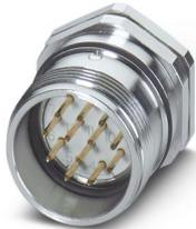
M23, Conector de encaixe para equipamento parede frontal, série: RC, reto, blindado: sim, Travamento parafusado, Número de pólos: 12, Sentido de rotação: Padrão, tipo de contato: Pino, Cálice de solda, Anel de vedação radial, Espessura mín. da parede: 0,8 mm, Espessura máx. da parede: 6,5 mm, codificação: N, espera-se que esse artigo seja isento de chumbo a partir de 2026-Q1, de acordo com RoHS II, sem exceção 6c (Pb < 0,1%); alternativa sem chumbo possível mediante solicitação antecipada
