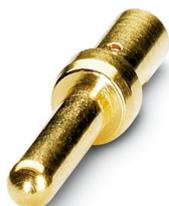
Contato para crimp, Pino, Girado, diâmetro de contato: 1 mm, bitola de conexão: 0,08 mm<sup>2</sup> ... 0,22 mm<sup>2</sup>, material de contato: CuZn , Produto alternativo conforme RoHS II sem exceção 6c (Pb < 0,1 %) código: 1240882
