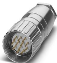
M23, Conector para cabos, série: RC, reto, blindado: não, Travamento parafusado, Número de pólos: 8+1, Sentido de rotação: Padrão, tipo de contato: Pino, Cálice de solda, codificação: N, espera-se que esse artigo seja isento de chumbo a partir de 2025-Q4, de acordo com RoHS II, sem exceção 6c (Pb < 0,1%); alternativa sem chumbo possível mediante solicitação antecipada
