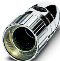
Caixa para conector de encaixe circular, série: RC, reto, Travamento parafusado, M23, número de polos: 12, blindado: não, faixa de diâmetro de cabo: 2 mm... 10,5 mm, espera-se que esse artigo seja isento de chumbo a partir de 2027-Q1, de acordo com RoHS II, sem exceção 6c (Pb < 0,1%); alternativa sem chumbo possível mediante solicitação antecipada
