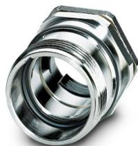
Caixa para conector de encaixe circular, série: RC, reto, Travamento parafusado, M23, Anel de vedação radial, blindado: sim, espessura da parede min.: 0,8 mm, espessura da parede máx.: 6,5 mm, espera-se que esse artigo seja isento de chumbo a partir de 2026-Q1, de acordo com RoHS II, sem exceção 6c (Pb < 0,1%); alternativa sem chumbo possível mediante solicitação antecipada
