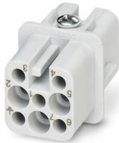
Inserto de contato, número de polos: 7+PE, tamanho: D7, quantidade de conexões por polo: 1, Soquete, Conexão para crimp, 250 V, 10 A, 0,14 mm<sup>2</sup> ... 2,5 mm<sup>2</sup>, só adequado para caixas de plástico
