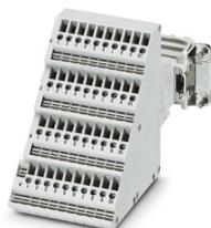
Adaptador para bornes HEAVYCON contato fêmea, série D40, 40 pólos, conexão do condutor de proteção esquerda para parede direita do painel de comando, conexão a parafuso
