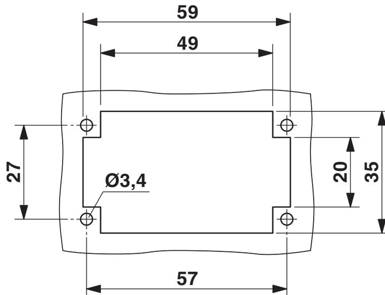
Recorte de montagem para aplicação sem caixa
