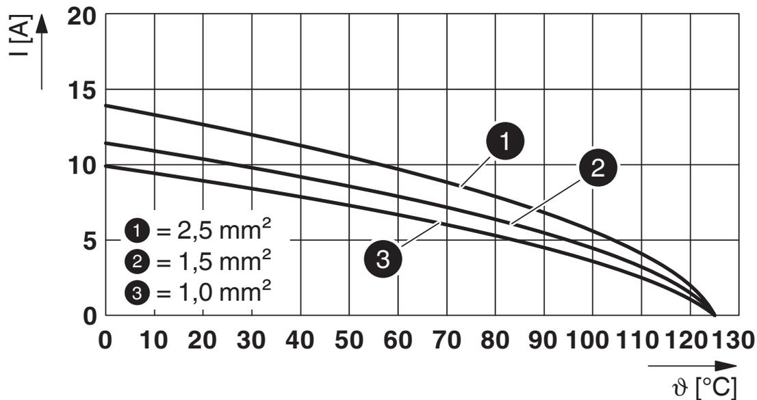
Diagrama de redução de carga de contatos em espiral
