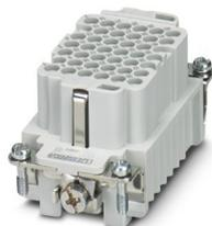
Inserto de contato, número de polos: 42+PE, tamanho: B10, quantidade de conexões por polo: 1, Soquete, Conexão para crimp, 250 V, 10 A, 0,14 mm<sup>2</sup> ... 2,5 mm<sup>2</sup>, aplicação: Sinal
