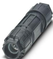
Conector de cabo, tipo de conexão: Conexão IDC, número de polos: 3+PE, 1 mm<sup>2</sup> ... 2,5 mm<sup>2</sup>, 690 V, 20 A, PA, preto, Com duas porcas do parafuso QUICKON, codificação: Perfil de codificação, diâmetro externo de linha: 9 mm ... 14 mm
