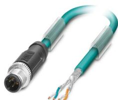
Cabo de rede, Ethernet CAT5 (100 MBit/s), 4-polos, PUR sem halogênio, azul anil RAL 5021, blindado (Advanced Shielding Technology), Conector reto M12, codificação: D / IP67, para extremidade livre do condutor, comprimento de cabo: 10 m
