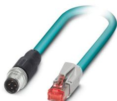
Cabo Ethernet montado, CAT5e, blindado, 2 pares, AWG 26 flexível (7 fios), RAL 5021 (azul água), M12, 4 polos, codificação D sobre conector RJ45, comprimento: 3 m, variante do cliente
