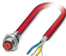
Conector de encaixe para equipamento parede posterior, CC-Link, 4-polos, PVC, vermelho, semelhante a RAL 3000, Soquete, reto, M12-SPEEDCON, A-codificação, para extremidade livre do condutor, Conexão para cabo, comprimento de cabo: 5 m, CC-Link, espera-se que esse artigo seja isento de chumbo a partir de 2026-Q2, de acordo com RoHS II, sem exceção 6c (Pb < 0,1%); alternativa sem chumbo possível mediante solicitação antecipada
