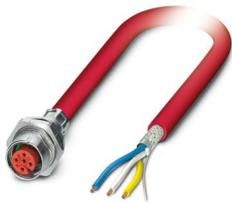
Conector de encaixe para equipamento parede posterior, CC-Link, 4-polos, PVC, vermelho, semelhante a RAL 3000, Soquete, reto, M12-SPEEDCON, codificação: A, para extremidade livre do condutor, Montagem na parede posterior, M16 x 1,5, Conexão para cabo, comprimento de cabo: 0,5 m, CC-Link, espera-se que esse artigo seja isento de chumbo a partir de 2026-Q2, de acordo com RoHS II, sem exceção 6c (Pb < 0,1%); alternativa sem chumbo possível mediante solicitação antecipada
