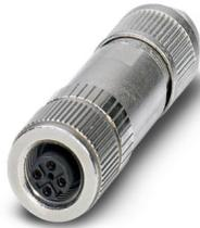
Conector de dados, CC-Link, 4-polos, blindado, Soquete reto M12, codificação: A, Conexão à mola, material serrilhado: Latão, niquelado, diâmetro externo de linha 4 mm ... 8 mm
