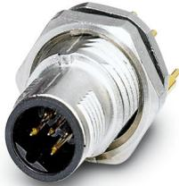
Conector de encaixe para equipamento parede posterior, 5-polos, Pino, reto, M12-SPEEDCON, B-codificação, Solda por onda, espera-se que esse artigo seja isento de chumbo a partir de 2026-Q2, de acordo com RoHS II, sem exceção 6c (Pb < 0,1%); alternativa sem chumbo possível mediante solicitação antecipada
