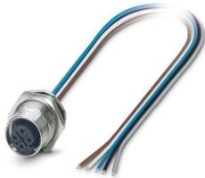
Conector de encaixe para equipamento parede posterior, Universal, 5-polos, Soquete, reto, M12-SPEEDCON, B-codificação, para extremidade livre do condutor, Cabos individuais, comprimento de cabo: 0,5 m, 0,34 mm<sup>2</sup>, Cabo TPE, encapsulado, espera-se que esse artigo seja isento de chumbo a partir de 2026-Q2, de acordo com RoHS II, sem exceção 6c (Pb < 0,1%); alternativa sem chumbo possível mediante solicitação antecipada
