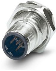
Conector de encaixe para equipamento parede posterior, 5-polos, Pino, reto, M12-SPEEDCON, B-codificação, Solda por onda, espera-se que esse artigo seja isento de chumbo a partir de 2026-Q2, de acordo com RoHS II, sem exceção 6c (Pb < 0,1%); alternativa sem chumbo possível mediante solicitação antecipada
