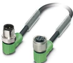
Cabo para sensor/atuador, 4-polos, PUR sem halogênio, preto acinzentado RAL 7021, Conector angular M12 SPEEDCON, codificação: A, para Soquete angular M12 SPEEDCON, codificação: A, comprimento de cabo: 5 m
