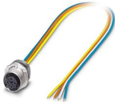
Conector de encaixe para equipamento parede frontal, PROFINET CAT5 (IEC 11801:2002), 4-polos, Soquete, reto, M12-SPEEDCON, D-codificação, para extremidade livre do condutor, Cabos individuais, comprimento de cabo: 0,5 m, 0,34 mm<sup>2</sup>, Cabo TPE, encapsulado, Artigo sem chumbo de acordo com RoHS II sem exceção 6c (Pb < 0,1 %)
