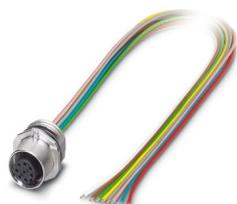
Conector de encaixe para equipamento parede frontal, Universal, 8-polos, Soquete, reto, M12-SPEEDCON, A-codificação, para extremidade livre do condutor, Cabos individuais, comprimento de cabo: 0,5 m, 0,25 mm<sup>2</sup>, Cabo TPE, encapsulado, espera-se que esse artigo seja isento de chumbo a partir de 2025-Q4, de acordo com RoHS II, sem exceção 6c (Pb < 0,1%); alternativa sem chumbo possível mediante solicitação antecipada
