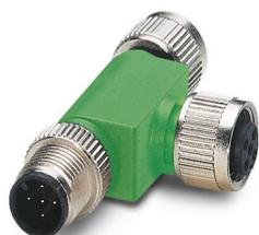
Distribuidor T, 5-polos, não blindado, Conector reto M12, codificação: A, para Soquete reto M12, codificação: A, PIN 2+4 jumpeado e Soquete reto M12, codificação: A, PIN 2+4 jumpeado
