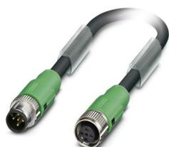
Cabo para sensor/atuador, 5-polos, PUR, preto acinzentado RAL 7021, Conector reto M12 SPEEDCON, codificação: A, para Soquete reto M12 SPEEDCON, codificação: A, comprimento de cabo: 1 m
