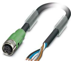
Cabo para sensor/atuador, 5-polos, PUR, preto acinzentado RAL 7021, extremidade livre do condutor, para Soquete reto M12 SPEEDCON, codificação: A, comprimento de cabo: 15 m
