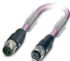
Cabo de sistema Bus, PROFIBUS (12 MBit/s), 2-polos, PUR sem halogênio, violeta RAL 4001, blindado, Conector reto M12 SPEEDCON, codificação: B, para Soquete reto M12 SPEEDCON, codificação: B, comprimento de cabo: 1 m
