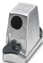
Caixa de buchas HEAVYCON ADVANCE B16, com travamento baioneta (sextavado interno) de aço inoxidável, alumínio resistente à água do mar, altura 100 mm, com rosca 1x M40, saída de cabo lateral, sem superfície; vedação condutora (propriedades EMC)
