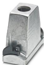
Caixa de buchas HEAVYCON ADVANCE B16, com travamento baioneta (sextavado interno) de aço inoxidável, alumínio resistente à água do mar, altura 100 mm, com rosca 1x M40, saída de cabo reta, sem superfície; vedação condutora (propriedades EMC)
