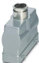
Caixa de buchas HEAVYCON B24, para arco transversal, altura 76 mm, com conexão roscada 1x M32, com saída de cabo reta
