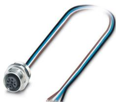
Conector de encaixe para equipamento parede frontal, Universal, 4-polos, Soquete, reto, M12-Padrão, codificação: A, para extremidade livre do condutor, Montagem frontal, M16 x 1,5, Cabos individuais, comprimento de cabo: 0,5 m, 0,34 mm<sup>2</sup>, Cabo TPE, encapsulado
