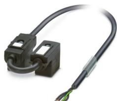
Cabo para conector duplo de válvula, 4-polos, PUR/PVC, preto, extremidade livre do condutor, para Conector de válvula BI (11 mm), com 1 LED, Ligaç o: Diodo Z e Conector de válvula BI (11 mm), com 1 LED, Ligaç o: Diodo Z, comprimento de cabo: 5 m, dist ncia do conector de válvula: 0,15 m
