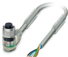
Cabo para sensor/atuador, 5-polos, PUR sem halogênio, resistente a faíscas de solda, altamente flexível, cinza RAL 7001, extremidade livre do condutor, para Soquete angular M12, codificação: A, com 3 LEDs, comprimento de cabo: 10 m, para robôs e correias de arraste
