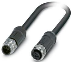
Cabo para sensor/atuador, 4-polos, PE-X/PE-X sem halogênio, preto acinzentado RAL 7021, blindado, Conector reto M12, codificação: A, para Soquete reto M12, codificação: A, comprimento de cabo: 2 m, para aplicações no exterior, com serrilha de aço inoxidável
