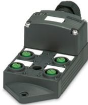
Caixa de distribuição, aplicação: Padrão, tipo de conexão: Conector M12 Plástico, número de pontos de encaixe: 4, número de polos: 5, codificação: A, atribuição do ponto de encaixe: duplo, indicação de estado: não, Universal; conexão do cabo padrão: Conexão à mola 180°, blindagem: não
