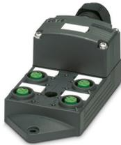
Caixa de distribuição, aplicação: Padrão, tipo de conexão: Conector M12 Plástico, número de pontos de encaixe: 4, número de polos: 4, codificação: A, atribuição do ponto de encaixe: simples, indicação de estado: não, Universal; conexão do cabo padrão: Conexão à mola 180°, blindagem: não
