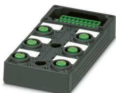
Régua básica da caixa de distribuição, aplicação: Padrão, tipo de conexão: Conector M12 Plástico, número de pontos de encaixe: 6, número de polos: 5, codificação: A, atribuição do ponto de encaixe: duplo, indicação de estado: sim, PNP; conexão do cabo padrão: Conexão a parafuso plugável, blindagem: não
