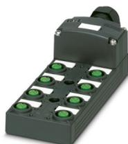
Caixa de distribuição, aplicação: Padrão, tipo de conexão: Conector M12 Plástico, número de pontos de encaixe: 8, número de polos: 5, codificação: A, atribuição do ponto de encaixe: duplo, indicação de estado: sim, PNP; conexão do cabo padrão: Conexão a parafuso plugável 180°, blindagem: não
