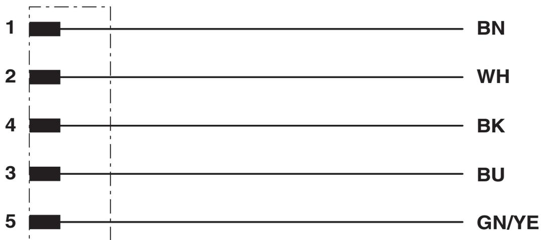
Esquema de ligação do conector M12
