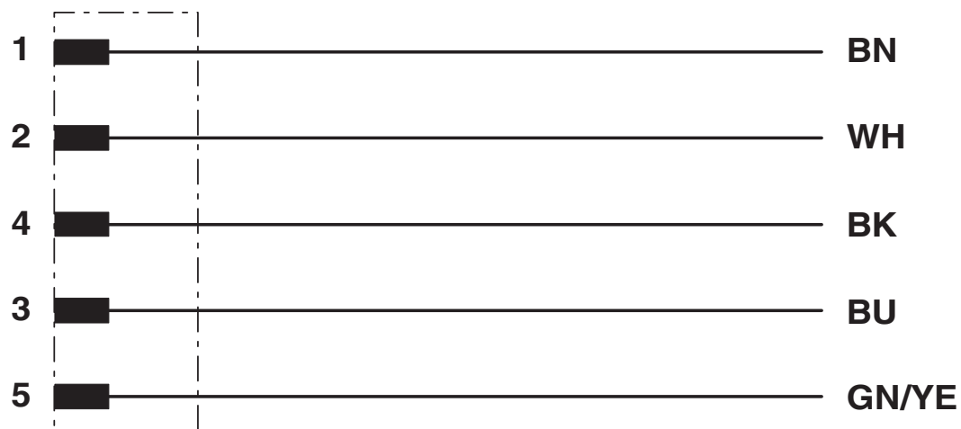
Esquema de ligação do conector M12
