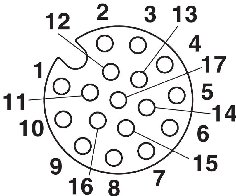
Imagem com pólos soquete M12, 17 pólos, codificação A, vista lado do soquete
