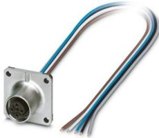
Conector de encaixe para equipamento parede frontal, 5-polos, Soquete, reto, M12, B-codificação, para extremidade livre do condutor, Cabos individuais, comprimento de cabo: 0,5 m, 0,34 mm<sup>2</sup>, Cabo TPE, encapsulado, espera-se que esse artigo seja isento de chumbo a partir de 2026-Q2, de acordo com RoHS II, sem exceção 6c (Pb < 0,1%); alternativa sem chumbo possível mediante solicitação antecipada
