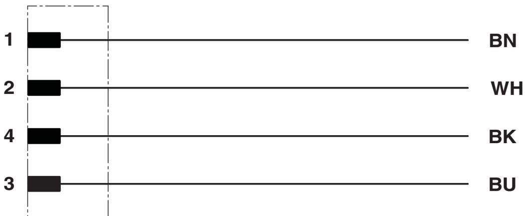
Esquema de ligação do conector M12
