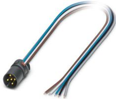
Porta-contatos, 4-polos, Pino, reto, M12, A-codificação, para extremidade livre do condutor, Cabos individuais, comprimento de cabo: 0,5 m, 0,34 mm<sup>2</sup>, Cabo TPE, espera-se que esse artigo seja isento de chumbo a partir de 2026-Q1, de acordo com RoHS II, sem exceção 6c (Pb < 0,1%); alternativa sem chumbo possível mediante solicitação antecipada
