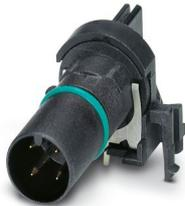
Porta-contatos, 4-polos, Pino, angular, M12, A-codificação, Solda por onda, Artigo sem chumbo de acordo com RoHS II sem exceção 6c (Pb < 0,1 %)
