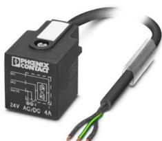
Cabo para sensor/atuador, 3-polos, PVC, preto RAL 9005, extremidade livre do condutor, para Conector de válvula A, com 1 LED, Ligação: Diodo Z, comprimento de cabo: 10 m
