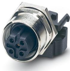
Conector de montagem sensor/atuador, soquete, 5 pólos, M12, blindado, codificação B, montagem posterior de painel/a parafuso com rosca M12, protegido contra torção, com conexão de solda reta
