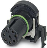
Porta-contatos, 8-polos, Soquete, angular, M12, A-codificação, Solda por onda, espera-se que esse artigo seja isento de chumbo a partir de 2026-Q1, de acordo com RoHS II, sem exceção 6c (Pb < 0,1%); alternativa sem chumbo possível mediante solicitação antecipada
