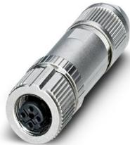
Conector de dados, PROFINET CAT5 (100 MBit/s), 4-polos, blindado, Soquete reto M12, codificação: D, Conexão à mola, material serrilhado: Fundição de zinco sob pressão, niquelado, diâmetro externo de linha 4 mm ... 8 mm
