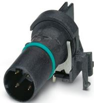
Porta-contatos, Ethernet/PROFINET CAT5 (100 MBit/s), 4-polos, Pino, angular, M12, D-codificação, Solda por onda, Artigo sem chumbo de acordo com RoHS II sem exceção 6c (Pb < 0,1 %)
