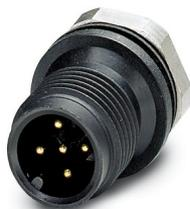
Conector de montagem sensor/atuador, plugue, 5 pólos, M12, codificação A, montagem frontal de painel/a parafuso com rosca M12, com pino de solda, versão de plástico
